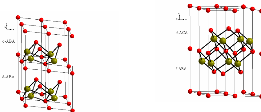
Рис. 8 - Схематичное представление Fe-O-Fe связей в фазе АВАВА(а) и в фазе АВАСА(б) по обозначению [15]. Мелкие кружки – лиганды О, ОН; крупные кружки – Fe 3+
