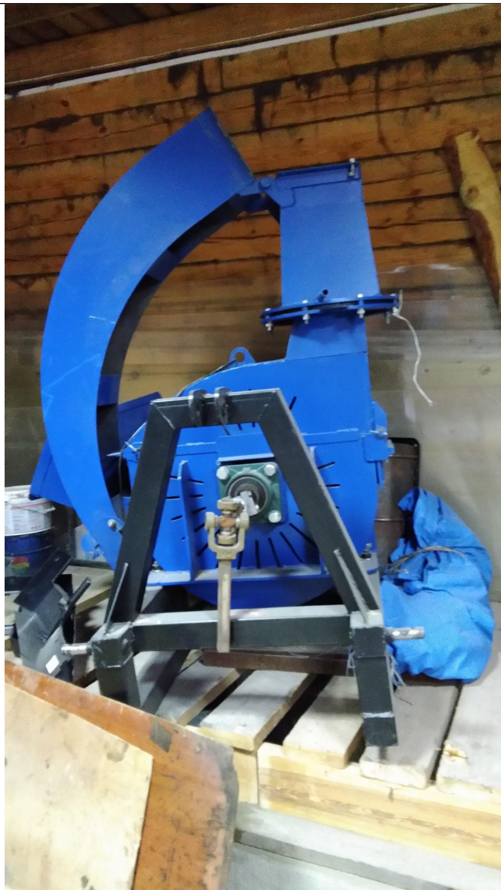
Рис. 1. В) Измельчитель веток навесной с приводом от ВОМ трактора.
