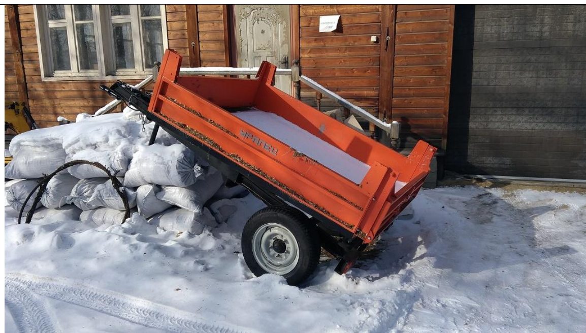
Рис. 1. А) Произведена закупка трактора МТЗ 622 «Беларусь» и навесного оборудования; Б) Полуприцеп самосвальный с приводом гидроцилиндра от гидросистемы трактора.
