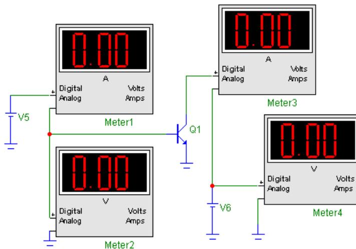
3. Исследовать работу усилительного каскада на биполярном транзисторе в режимах класса «А» и «С». Выполнить расчет компонентов схемы. Измерить АЧХ, ФЧХ каскада, вычислить коэффициент усиления. Марка транзистора такая же, как в задании №2.
