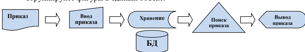
Рис. 3.1. Технологическая схема обработки документа
