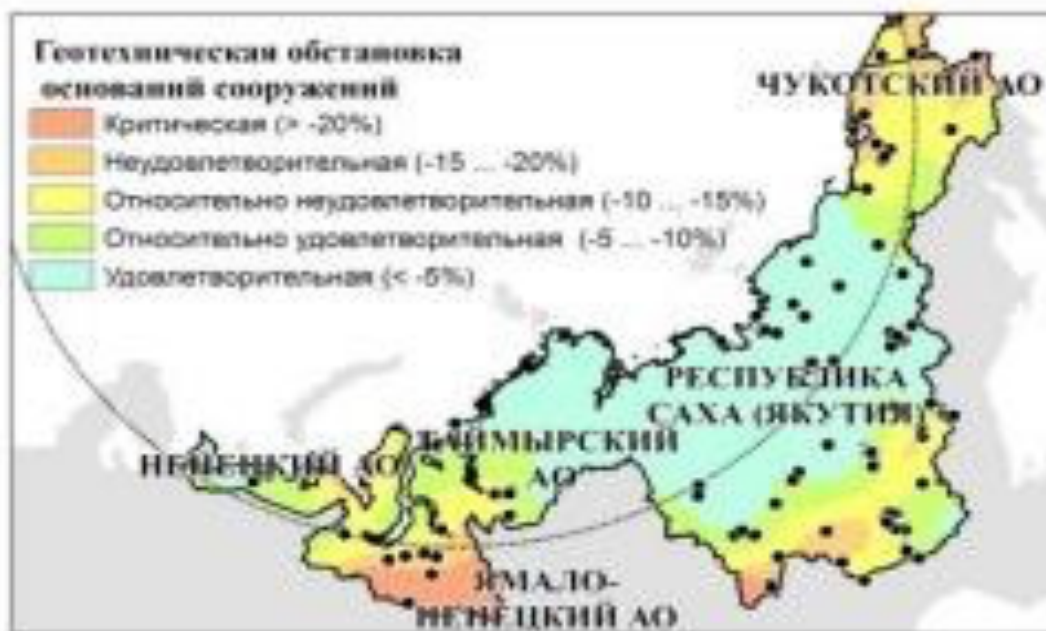
Изменения расчетной несущей способности свайных фундаментов в период между 1960–1970 гг. и 2000–2010 гг.
