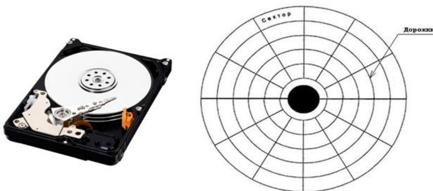
Структура поверхности магнитного диска
