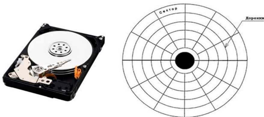
Структура поверхности магнитного диска
