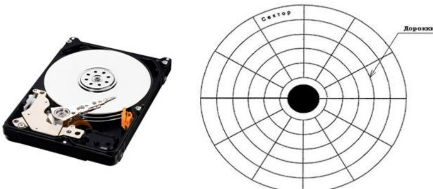
Структура поверхности магнитного диска
