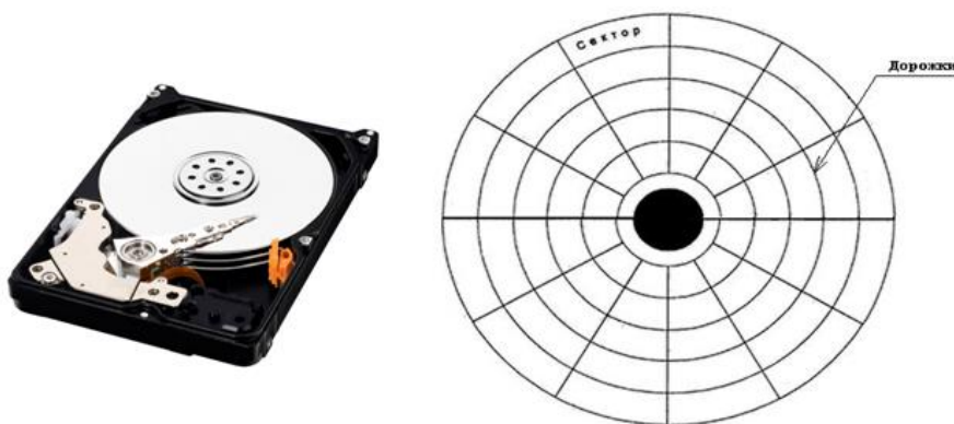
Структура поверхности магнитного диска
