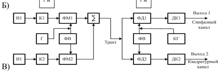
**8. Выберите структурную схему, соответствующую методу кодового уплотнения каналов.**
