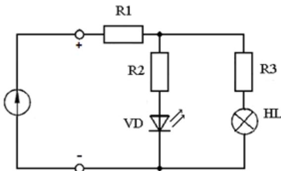
Требуется экспериментально определить **силу тока**, протекающую по резистору **R2**, с помощью **амперметра**. Выберите верную схему подключения амперметра в цепь.
