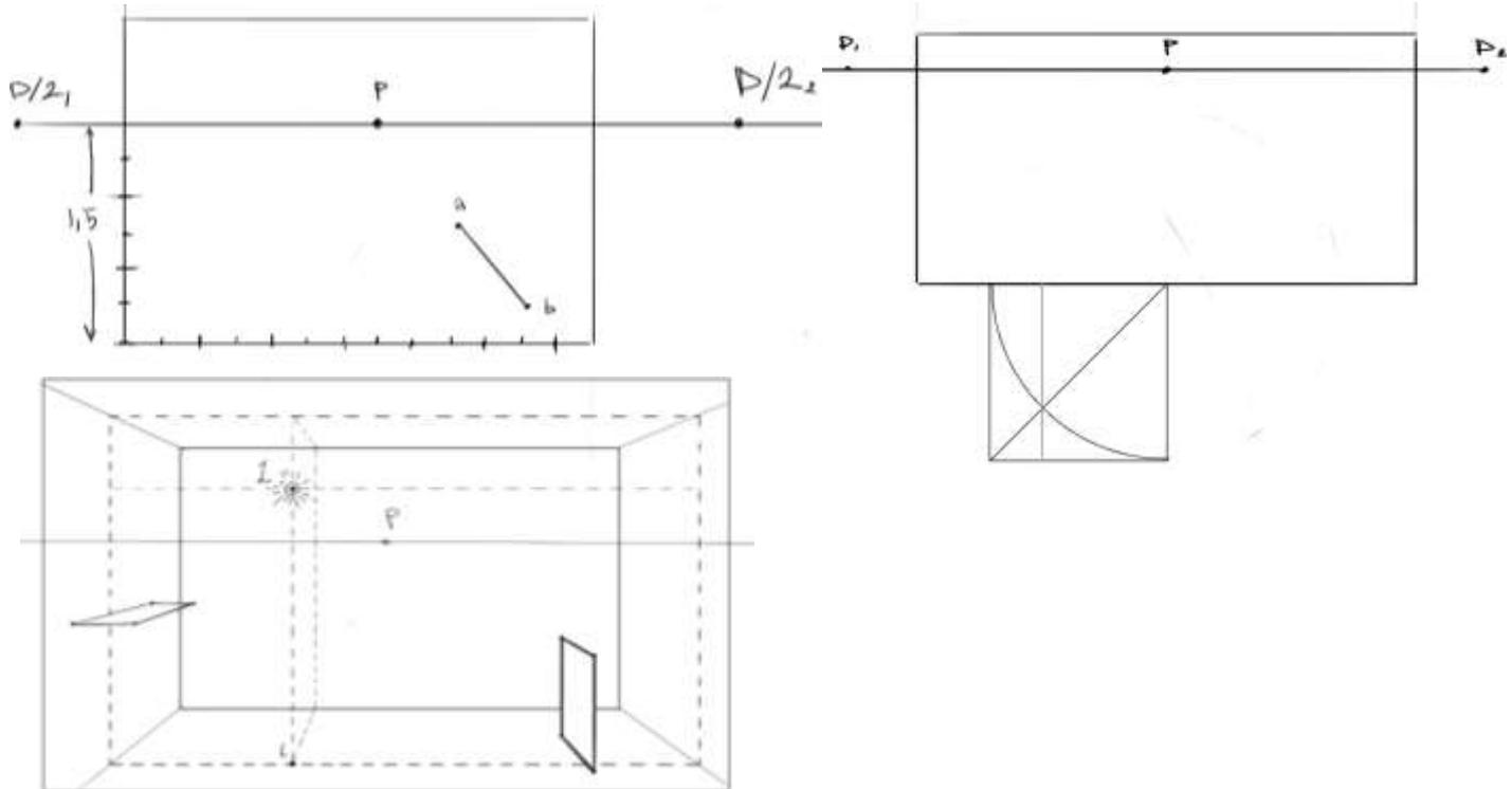
8) Постройте тени от вертикальной и горизонтальной планинки, используя положение светящейся точки L и его проекции на плоскости
