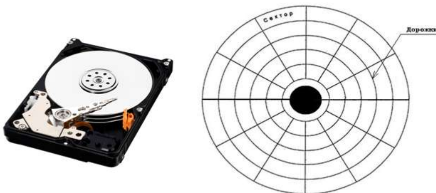
Структура поверхности магнитного диска
